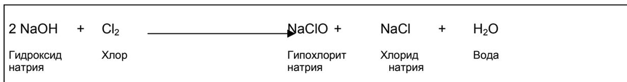
Для производства раствора гипохлорита натрия на месте имеются два различных процесса: установки для электролиза без и с мембранами. В то время как установки без мембраны имеют расположенные в одной трубе аноды и катоды (трубчатые установки для электролиза), в установках электролиза с мембраной анод отделен от катода мембраной.
