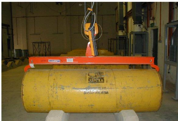
**Рис. 6** Подача газообразного хлора для транспортировки и установка ёмкостей с хлором в хранилище
