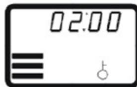
Цветная полоска в углу экрана показывает, что клапан находится в режиме фильтрации. Время начала регенерации 02:00 (Функция не доступна если клапан работает по часам)
