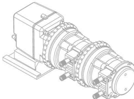
**Заметка** – подача вторичной головки полностью зависит от подачи вторичной. Для достижения максимальной производительности необходимо настроить контроллеры обеих головок на значение 10.
